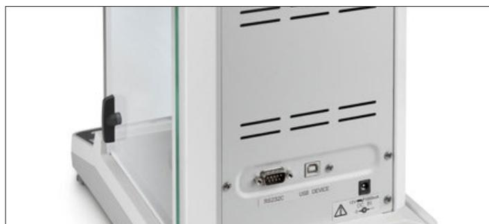
Interfaz de datos USB y RS-232 para transferir datos de pesaje a PC, tablet o impresora
