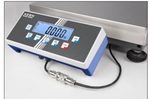
**2** Conector de homologación, permite, en el caso de balanzas verificadas, desconectarse del indicador y la plataforma sin interrumpir la verificación, por ejemplo, para la instalación posterior de la balanza en una mesa de embalaje y envío, un marco para foso etc. Al comprar la balanza deberá encargarlo también
