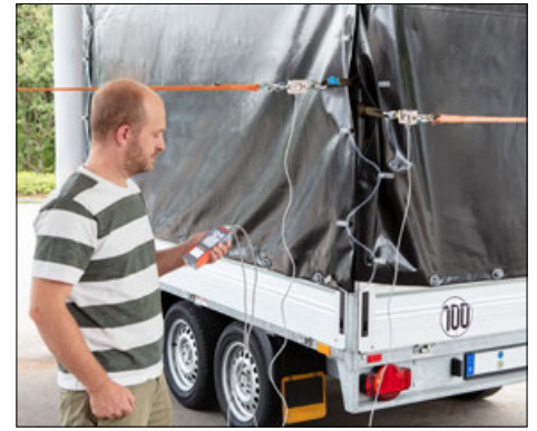
Posibilidad de medir fuerzas en diferentes direcciones de tracción o compresión con un solo instrumento de medición
