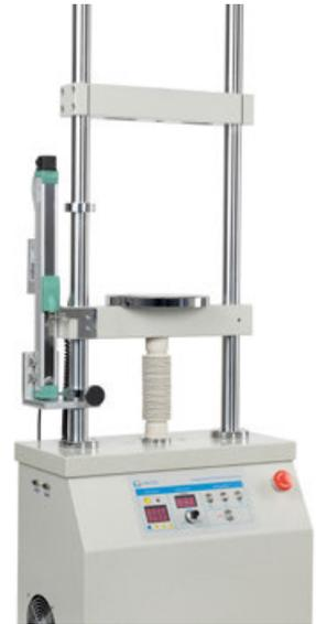
Banco de pruebas motorizado incl. sistema de medición de longitud LD
