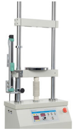
Banco de pruebas motorizado incl. sistema de medición de longitud LD
