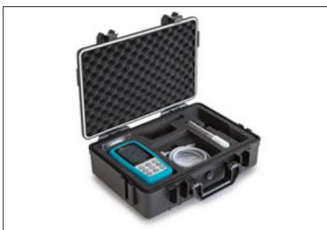
Materiale in dotazione: Blocco di durezza standard (ca. 61 HRC), cavo USB, unità display, unità sensore UCI, valigetta per il trasporto, software per il trasferimento dei dati salvati al PC, involucri protettivi (turchese), altri accessori
