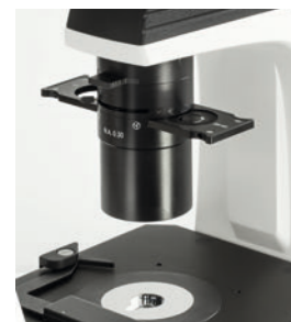
N.A. 0,3 Abbe Condenser with phase contrast slide
