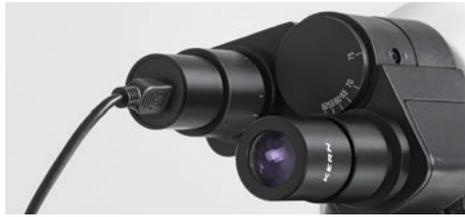
Okularkamera am Tubus befestigt
