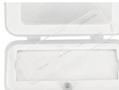
Zubehör: Objektmikrometer, für die Kalibrierung der Messfunktion der Software, KERN ODC-A2404, € 40,-
