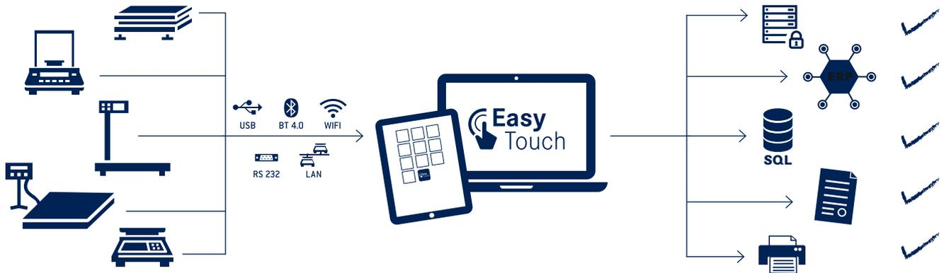
→ Une balance standard de notre ligne IoT est connectée à un ordinateur portable/une tablette extérieure
