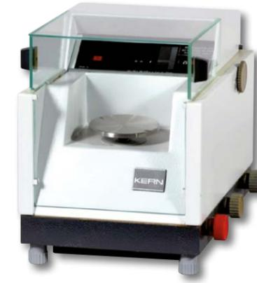
Oberschalige Präzisionswaage von 1977, der ersten elektronischen Generation KERN 810
