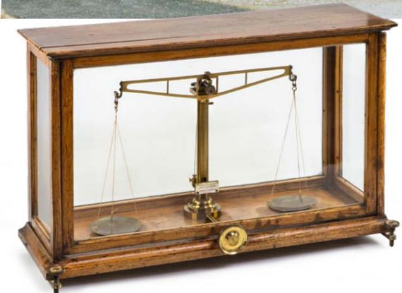
Präzisionswaage um 1840, im Glasgehäuse mit Milligramm-Empfindlichkeit
